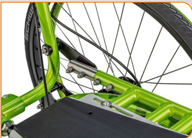
Sitzverlängerung (+7 cm nach hinten) seat extension (+7cm backwards)
