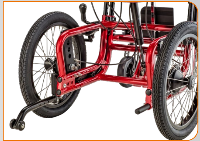
Kippsicherung und Ankippbügel anti-tip wheel and tip shackle
