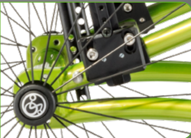
Kleiderschutzaufnahme clothing guard adaption
