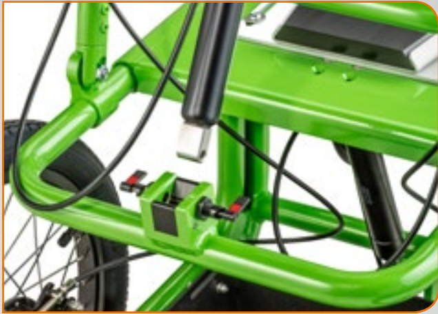
Rückenentriegelung back unlocking
