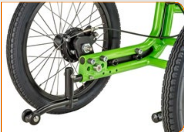
Kippsicherung abschwenkbar swing-away anti-tip wheel
