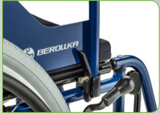
Verriegelung Desk-Seitenteil locking desk side guard
