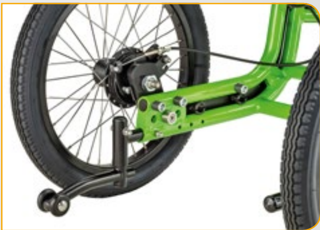
Kippsicherung abschwenkbar swing-away anti-tip wheel
