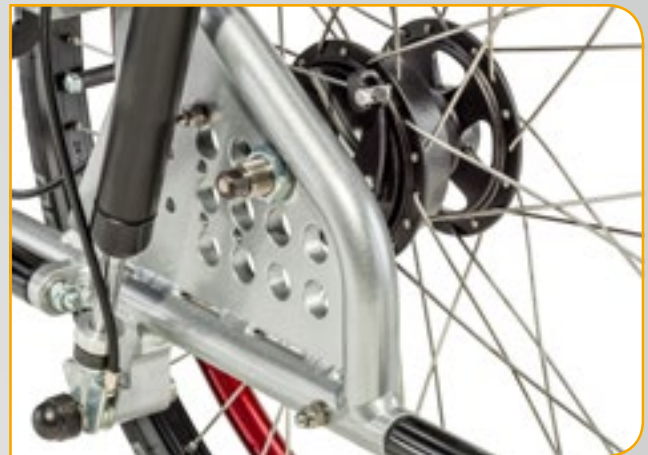
Antriebsradaufnahme und Gasdruckfederanbindung rear wheel adapter and gas spring adaption
