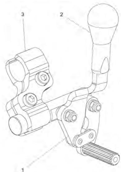
Kniehebelbremse mit Sonder-Bremshalter
