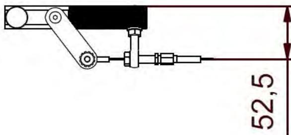
**Druckbremse für Begleitperson (= zusätzliche Kniehebelbremse für Begleitperson)**
