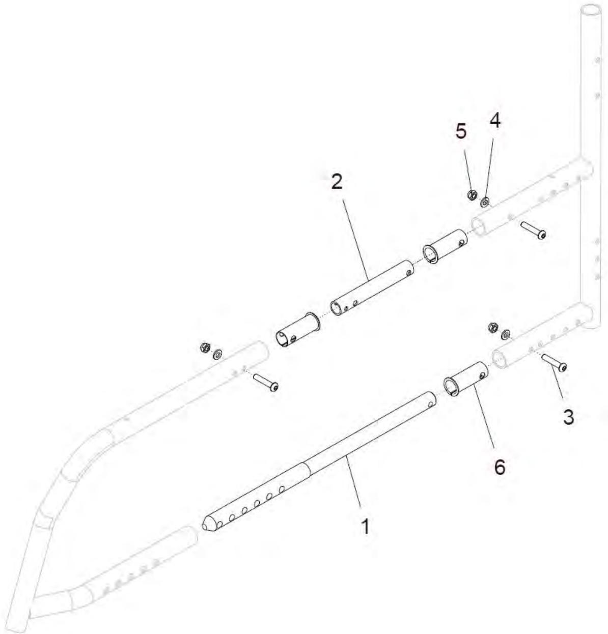
neue vordere Rahmenteile / neue Verbindungsachsen ab 04/2014
