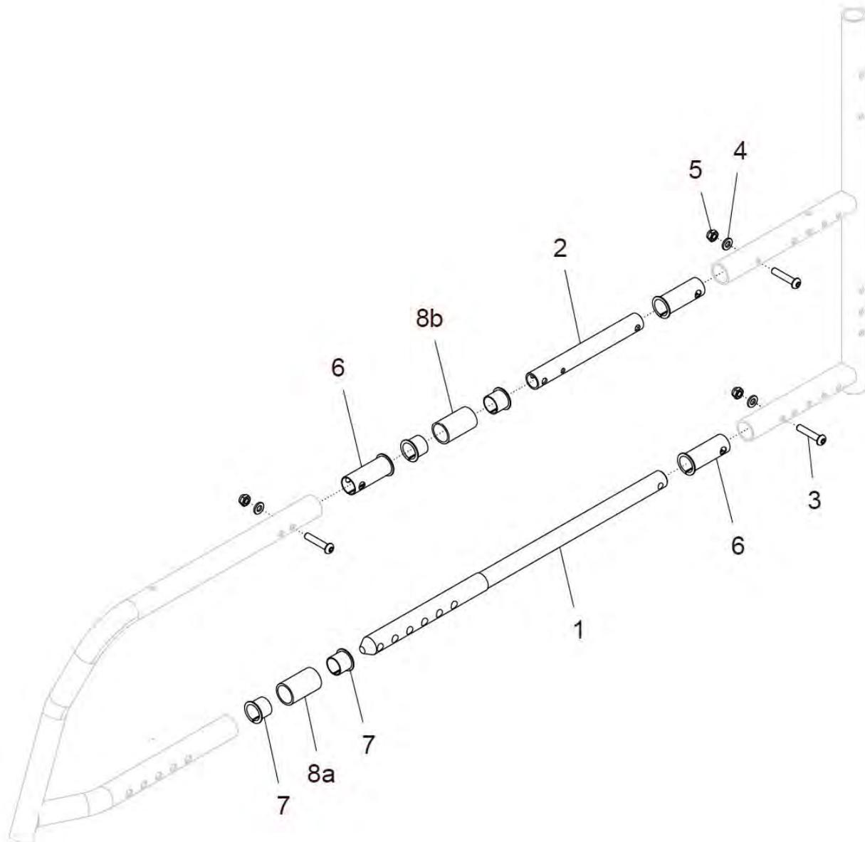
neue vordere Rahmenteile / neue Verbindungsachsen ab 04/2014
