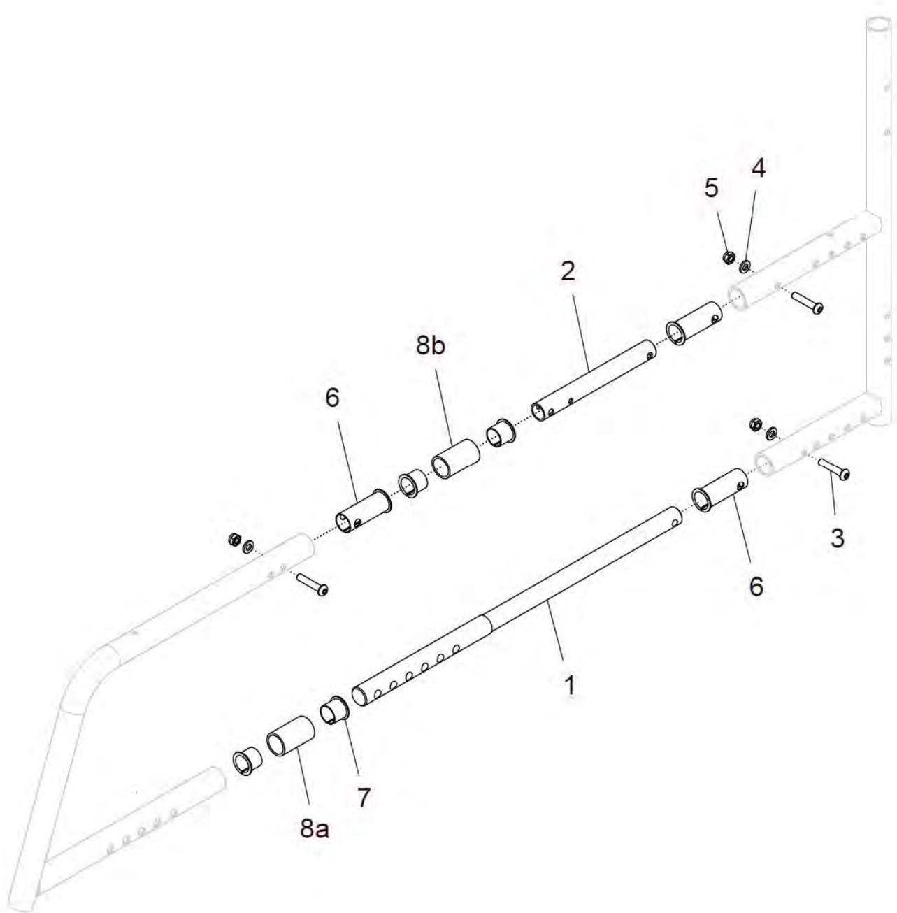
neue vordere Rahmenteile / neue Verbindungsachsen ab 04/2014
