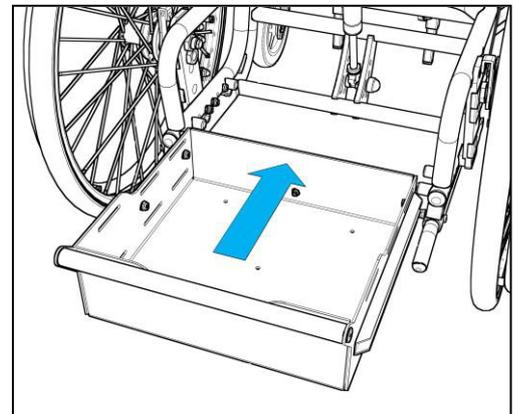
Zum Anbringen der Box schieben Sie die seitlichen Aluminiumführungen an der Box auf die Gleitbuchsen am Rahmen, so dass die Box hierauf gleitet. Die Box ist dann sicher arretiert wenn die Federklemmlaschen mit hörbarem Geräusch am Rahmenquerrohr einrastet.
