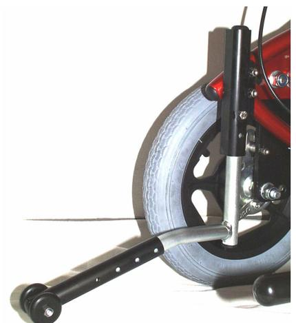
**Hinweis:** Beim Überfahren von Hindernissen bzw. Stufen muß die Kippsicherung um 180° nach vorne eingeschwenkt werden, um ein Aufsetzen zu vermeiden.
