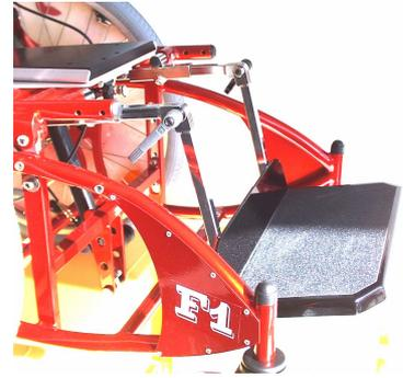
Das **Fußbrett mit dem Fußbretthalterrohr** wird am Sitzrahmen vorne eingeschoben und verschraubt. Dabei kann das Fußbrett durchgehend oder geteilt sein. Die Fußbretter sind hochklappbar und winkelverstellbar. Weiterhin kann über den Fußbrettbügel oder die Laschen die Unterschenkelänge individuell eingestellt werden.
