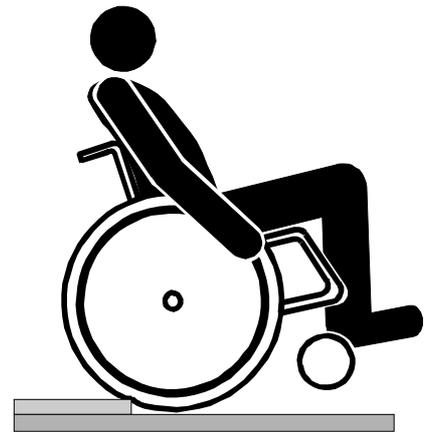
**ACHTUNG:** Wenn Sie auf vier Rädern eine Stufe herunterfahren müssen, d.h. ohne Ankippen, ist Vorsicht geboten, da Sturzgefahr besteht. Außerdem kann die Kippsicherung die Überwindung der Stufe gefährden, indem die Kippsicherungsräder auf der Stufe bleiben und die Antriebsräder frei in der Luft hängen bzw. nicht den Boden berühren. Bremsen, Antreiben und Lenken sind dabei nicht möglich.
