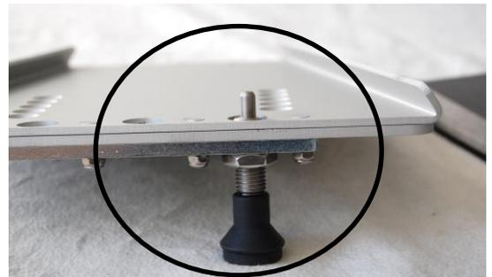
Der Arretierbolzen ist einzuschrauben und mit Schraubensicherungs-lack einzukleben, sowie mit der Kontermutter M12x1,5 zu kontern. Beachten Sie dabei das Bolzenmaß!
