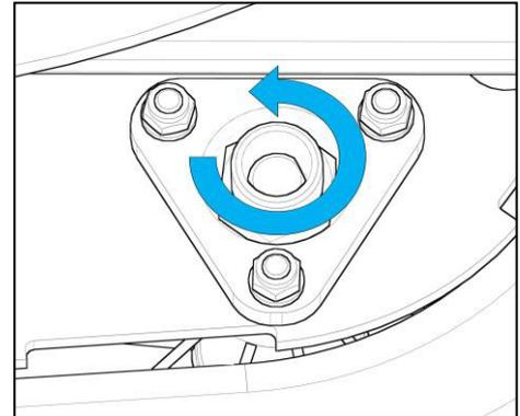
Die Steckachsenadapter werden in die Achsaufnahme eingeschoben und verschraubt. Je nach Sturz muss der Steckachsenadapter des Antriebsrades weiter nach außen oder innen verstellt und mit entsprechenden Distanzen unterlegt werden, damit das Rad nicht zu weit absteht oder umgekehrt am Seitenteil oder dem Bremsgestänge streift.
