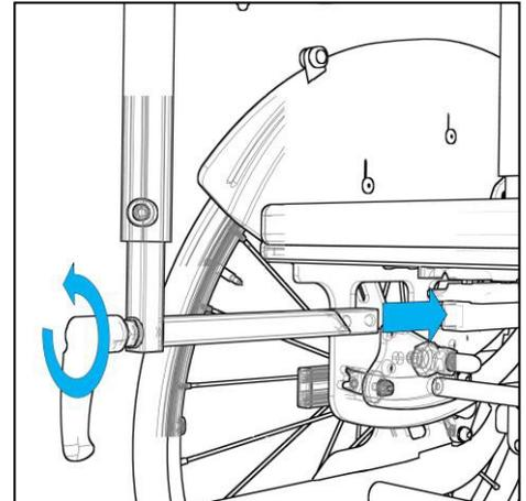
Zum Verstellen des Therapietisches müssen Sie wie gezeigt, die entsprechenden Verschraubungen lösen.
