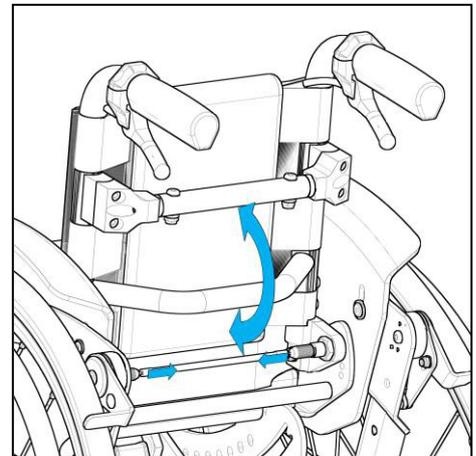
Der Rückenwinkel lässt sich somit in einem Bereich von 80° bis 120° in 10° Schritten verstellen. Ebenfalls können Sie den Rücken dadurch komplett abklappen, so dass dieser parallel auf der Sitzfläche liegt.
