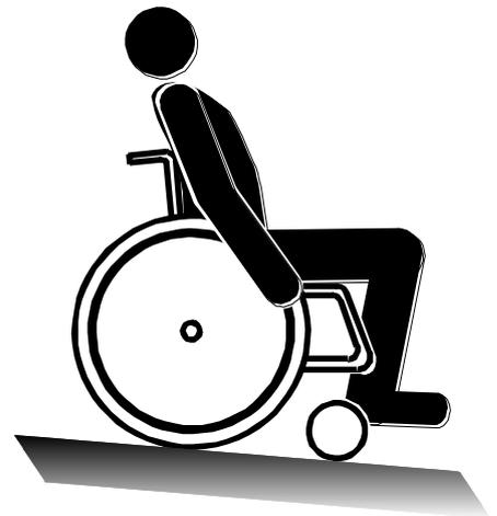
Achten Sie darauf, dass am Ende eines Gefälles die Fußbretter nicht den Boden berühren, da dadurch ein plötzliches, ungewolltes Bremsen Sie gefährden kann.
