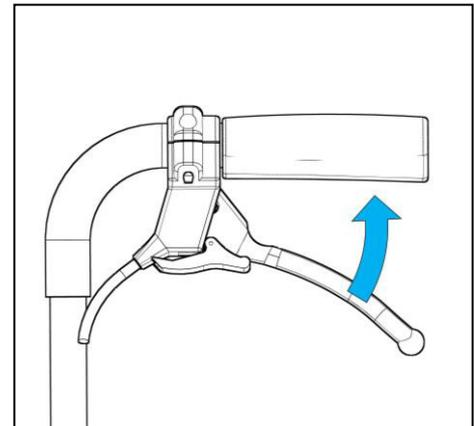
**Hinweis:** Ungleichmäßiges betätigen der beiden Bremshebel erzeugt eine Kurvenfahrt.
