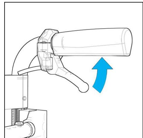
**Hinweis:** Es ist zu empfehlen das System ohne Last zu betätigen, was heißt, dass Sie beim Ziehen des Entriegelungshebels gleichzeitig das System etwas unterstützen, indem Sie das System in der „Waage“ halten.
