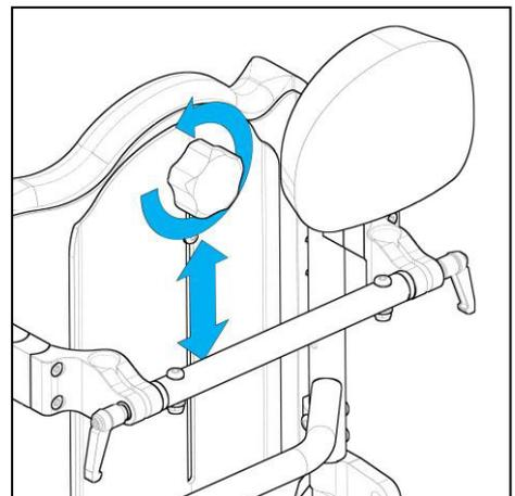
Zu aller erst entfernen Sie das Kopfpolster. Danach lösen Sie den Sterngriff am Rücken soweit, dass Sie die Rückenverlängerung leicht nach oben in die gewünschte Position herausziehen können. Danach ziehen Sie den Sterngriff wieder fest, so dass die Rückenverlängerung arretiert ist.
