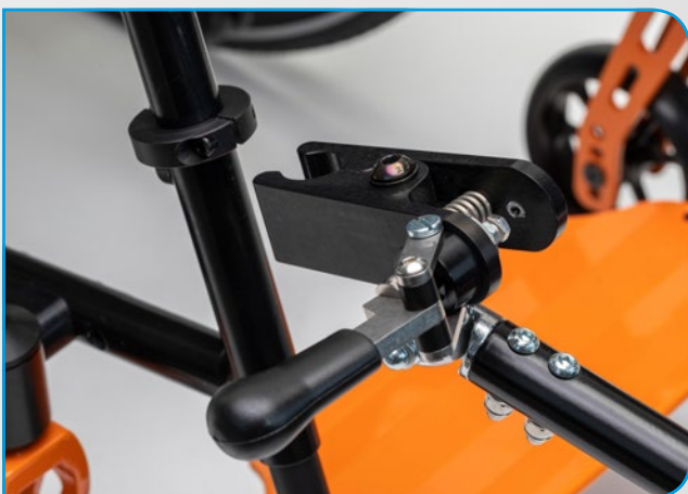
TRIKE Klemmung geöffnet TRIKE clamping opened
