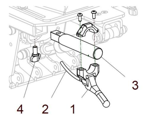
Befestigungsbolzen auf der linken Seite montiert
