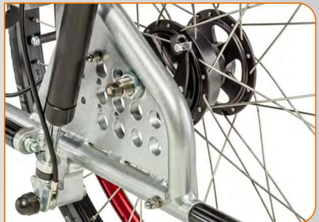
Antriebsradaufnahme und Gasdruckfederanbindung
