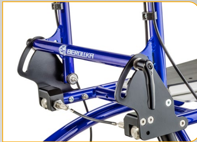
manuelle Rückenwinkelverstellung manuel back angle adjustment
