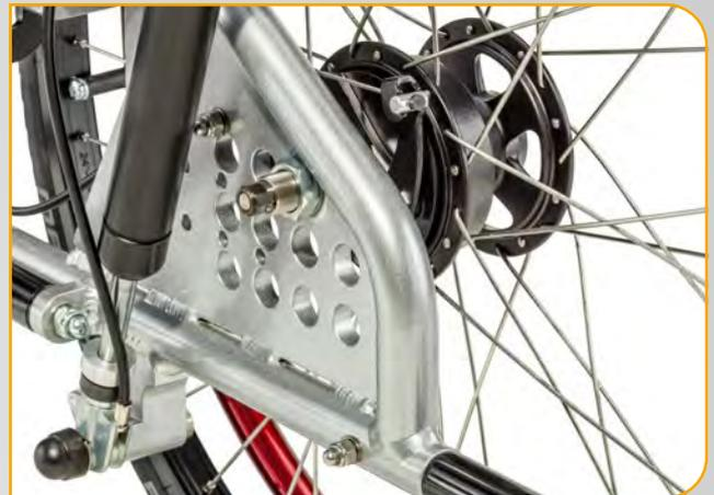
Antriebsradaufnahme und Gasdruckfederanbindung
