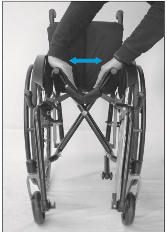
Um den Rollstuhl im entfalteten Zustand zu fixieren, drücken Sie nun soweit auf die Kreuzstrebenrohre, dass diese beidseitig in die Kreuzstrebenauflager einrasten.
