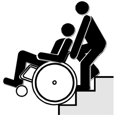
Beim **Hinauffahren** einer Treppe fahren Sie oder die Begleitperson den Rollstuhl rückwärts und senkrecht an die erste Treppenstufe heran. Die Begleitperson kippt den Rollstuhl auf die Antriebsräder und zieht den Rollstuhl an den Schiebegriffen Stufe für Stufe aufwärts.
