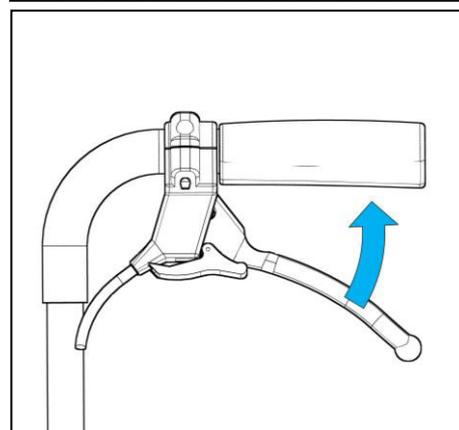
**Hinweis:** Ungleichmäßiges betätigen der beiden Bremshebel erzeugt eine Kurvenfahrt.
