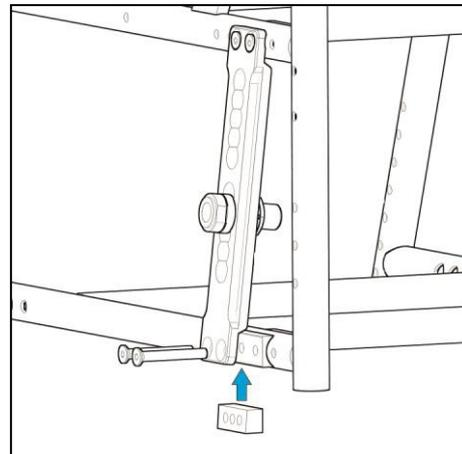
Beachten Sie bitte, dass bei großem Sturz der Einschraubadapter weiter herausragen muss, damit die Bereifung nicht gegen das Seitenteil drückt (streift).
