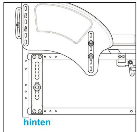
Ein Rollstuhl für Oberschenkelamputierte muss mit dem Bauteil Radstandsverlängerung ausgerüstet sein, da die Position "Lochplatte hinten" nicht ausreicht.
