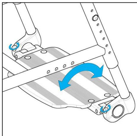
Das Fußbrett können Sie durch einfaches Anheben bis an das vordere Rahmenrohr hochklappen.
