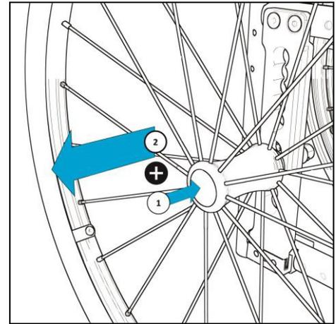
Durch die Möglichkeit die Antriebsräder werkzeuglos abnehmen zu können, entsteht der Vorteil diese jederzeit z.B. für den Transport des Rollstuhls entfernen zu können.
