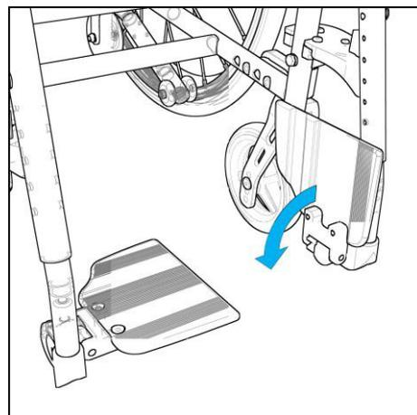
Der Fußbretthalter hochschwenkbar wird in der gleichen Reihenfolge an den Rollstuhl angebracht. Stellen Sie die Höhe des Fußbretthalters im unbelasteten Zustand ein und ziehen Sie den Klemmhebel fest an.
