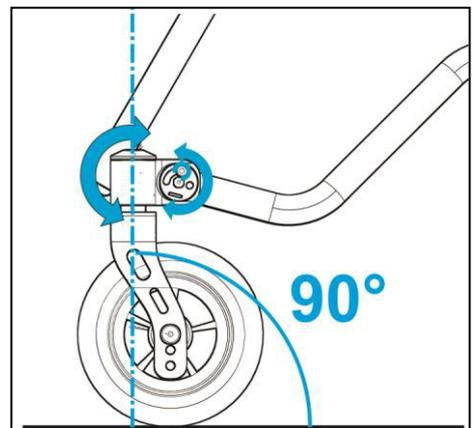
Ein optimales Fahrverhalten der Lenkräder und damit des Rollstuhls bringt grundsätzlich eine senkrecht zur Fahrbahn ausgerichtete Schraubachse des Lenkradadapters.
