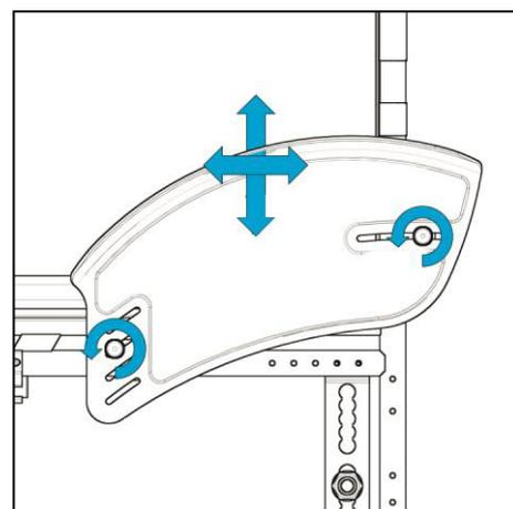
**Ziehen Sie die Verschraubungen wieder fest, um ein Lösen des Kleiderschutzes zu verhindern.**
