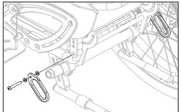
**Achtung: die Schraubverbindung ist mit Schraubensicherung gegen Lösen zu sichern.**
