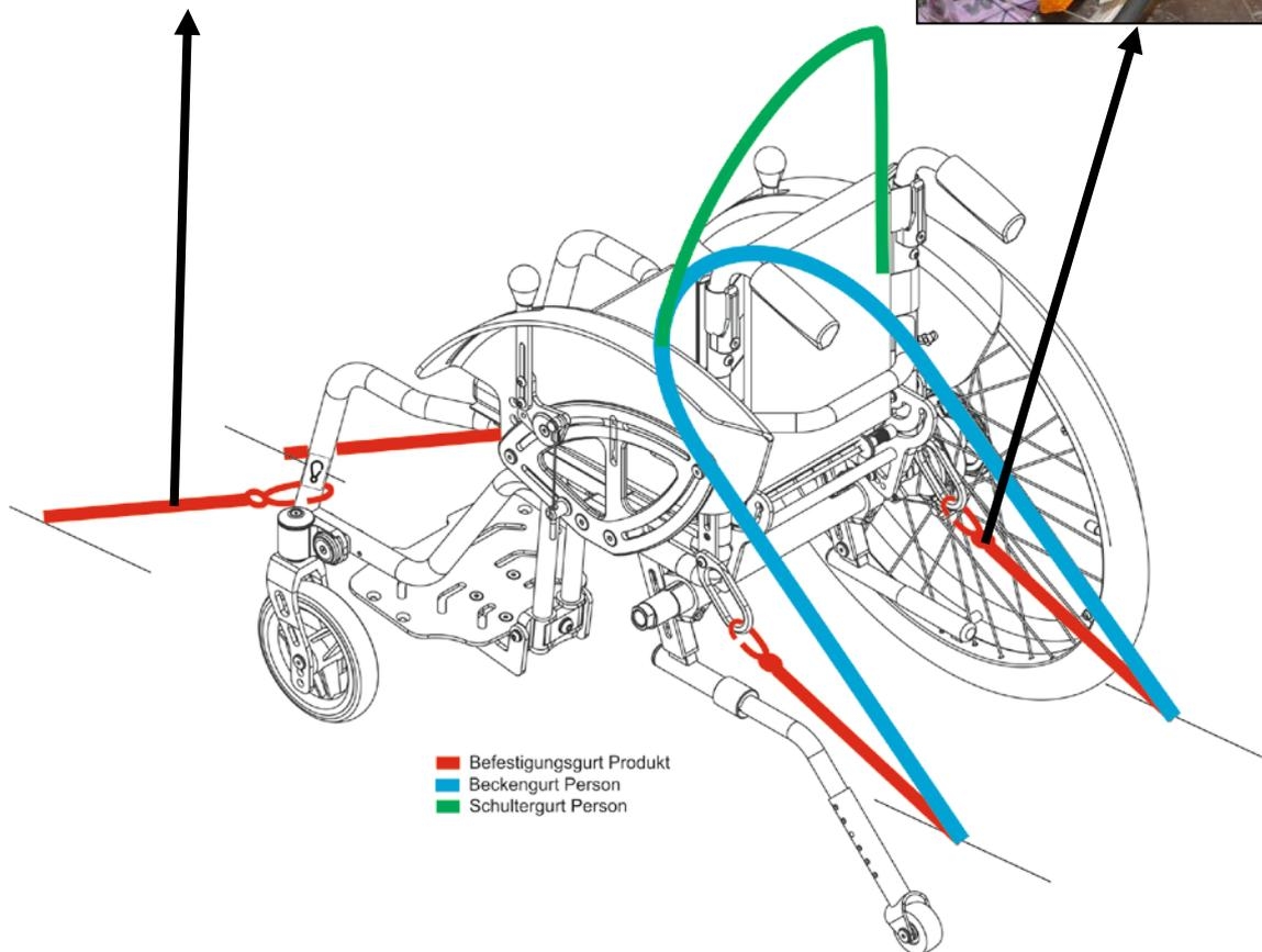
Achten Sie darauf, dass alle vier Gurte des Rollstuhl-Rückhaltesystems entsprechend der Vorgaben des Herstellers verspannt werden.
