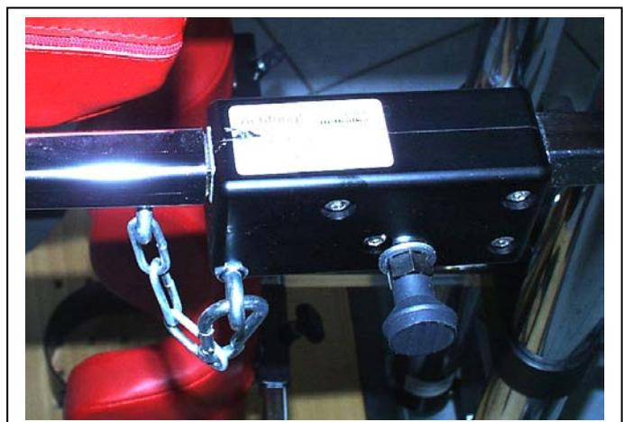
**Hinweis:** Nur bei eingehängter Sicherungskette und bei eingerastetem Sicherheitsbolzen darf das Stehgerät benutzt werden!
