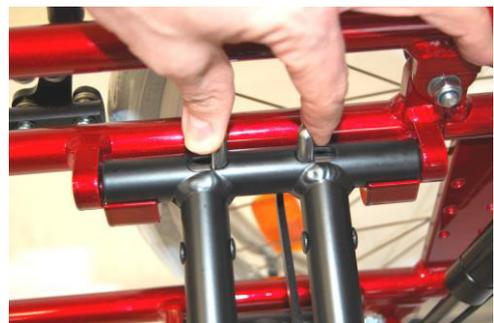
Anschließend klappen Sie den Rücken nach oben und verriegeln ihn Rücken mit den Rastbolzen.
