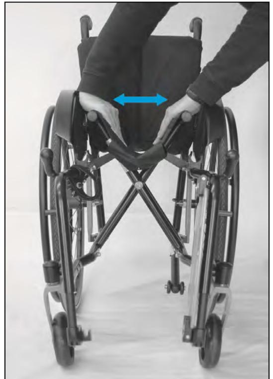
Um den Rollstuhl im entfaltetem Zustand zu fixieren, drücken Sie nun soweit auf die Kreuzstrebenrohre, dass diese beidseitig in die Kreuzstrebenauflager einrasten.
