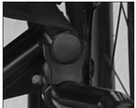
In der Anfangszeit müssen Sie beide Sitzrohre nochmals bis zum Anschlag nach unten in die Auflager drücken um den Rollstuhl vollständig zu entfalten.
