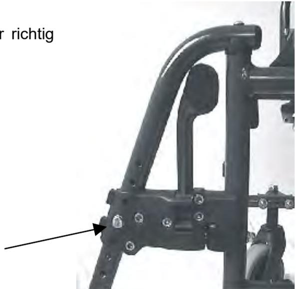
Das Fußbrett ist in seiner Position individuell einstellbar und kann verschiedenen Unterschenkellängen angepasst werden. Dazu müssen Sie den Fußbrettbügel verstellen, die durch eine Schraube mit dem Fußbretthalter verbunden sind. Durch Herausschrauben der Schraube können Sie die Fußbrettbügel nach oben oder unten (je nach Bedarf) verschieben um das Fußbrett Ihrer Unterschenkellänge anzupassen.
