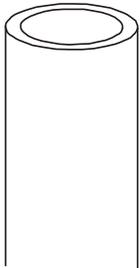
Rundrohr  $\text{\O}14 \times 2,0\text{mm}$
