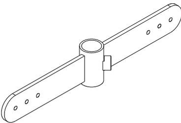
**Halter für Brustschultergurt an Kopfstützenrohr Ø18,7**
