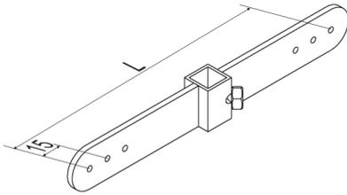
**Halter für Brustschultergurt an Kopfstützenrohr 15x15**
