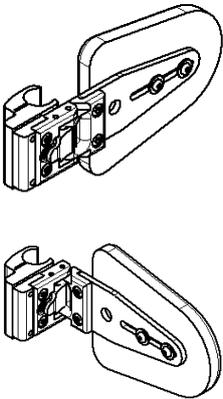
**Seitenpelotte flach abklappbar geklemmt am Rohr 19/23mm**
