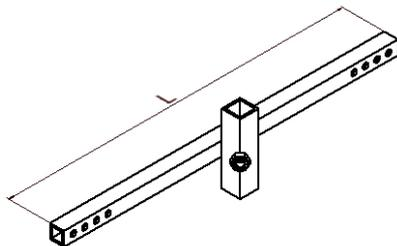
**Laschenträger an Kopfstützenrohr**
